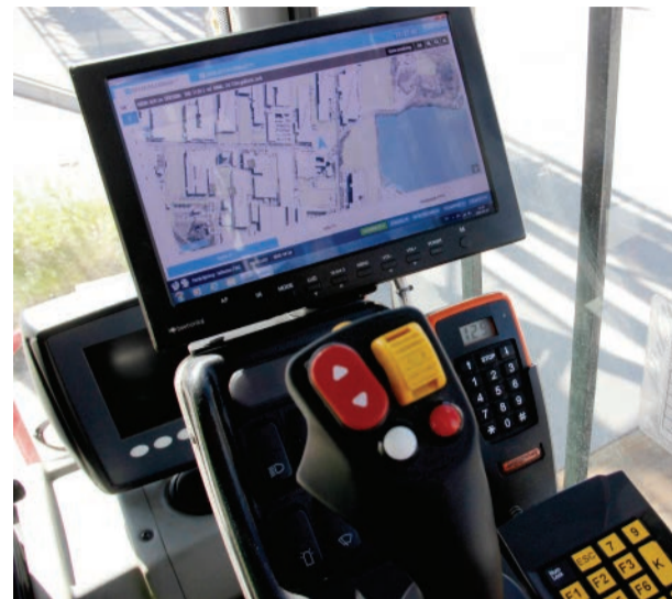
Så här ser det ut i trucken. På skärmen syns kartan av industriområdet, där fabriker, portar, lagerplatser med mera är inlagda.
